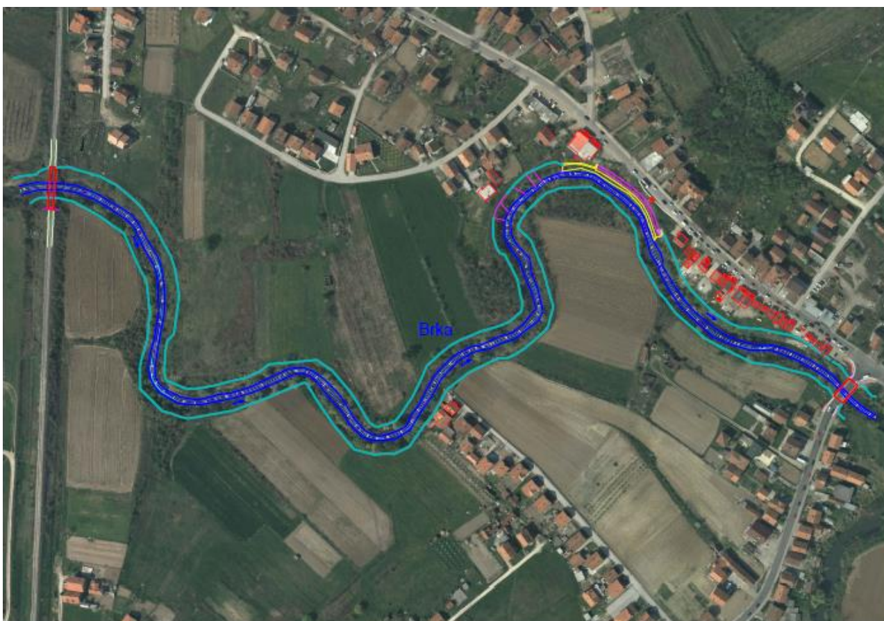
Slika 2.: Sadašnje stanje dionice regulacije rijeke Brke uzvodno od mosta na „Kožari“ do željezničkog mosta
