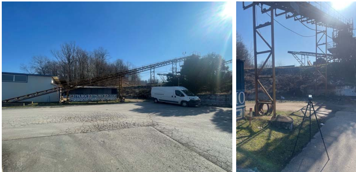
Slika 4: Transporter za dopremu šljunka na postrojenje separacije. (snimljeno stanje za monitoring mjerenja 2025.godine.
