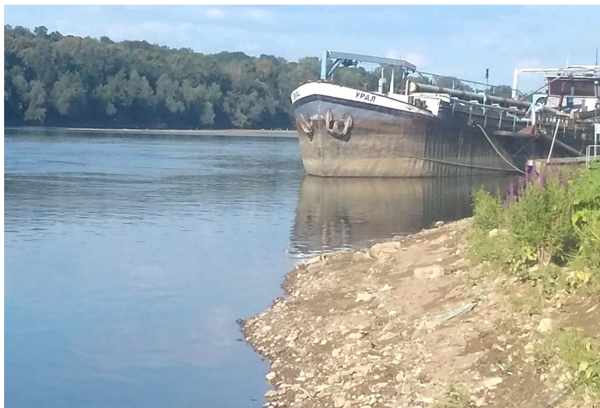
Slika 3: Plovni brod (refuler) za bagerovanje riječnog sadržaja: šljunak, pijesak, zemlja, trava..
